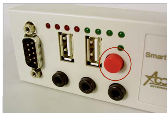
Na Smart Panelu II dołączymy do Acorpa 4D845A zamontowano przycisk umożliwiający PRZEŁĄCZANIE SIĘ MIĘDZY DWOMA BIOS-AMI .
